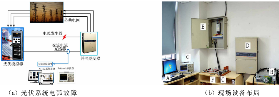
图 1 实验平台结构 Fig. 1 Structure of experiment platform
